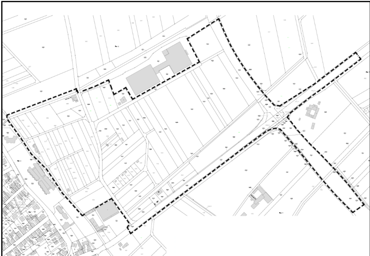
Abbildung 2 Übersichtskarte – Auszug aus dem Liegenschaftskataster mit Eintragung der Grenzen für den räumlichen Geltungsbereich des Bebauungsplans.
